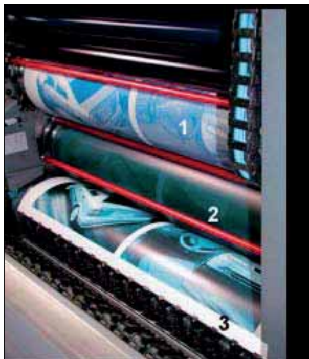
Druk-unit met een bedrukte pagina op de tegendrukcilinder
